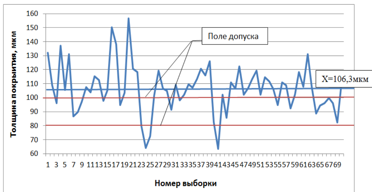
Рисунок 3 — Колебание толщины лакокрасочного покрытия левой части рамки
