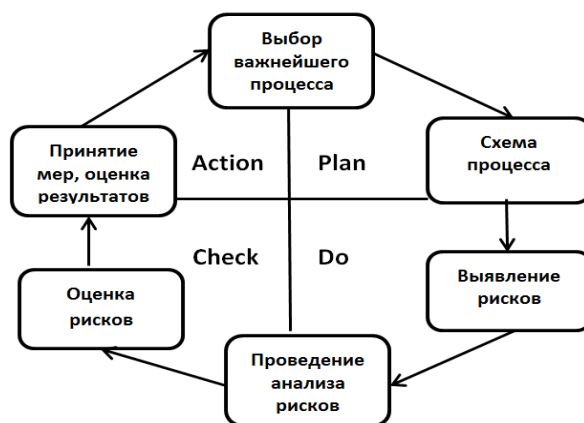
Рисунок 1 — Цикл управления (PDCA) в процессе выявления потенциальных отказов
