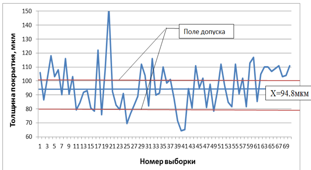
Рисунок 2 — Колебание толщины лакокрасочного покрытия нижней части рамки
