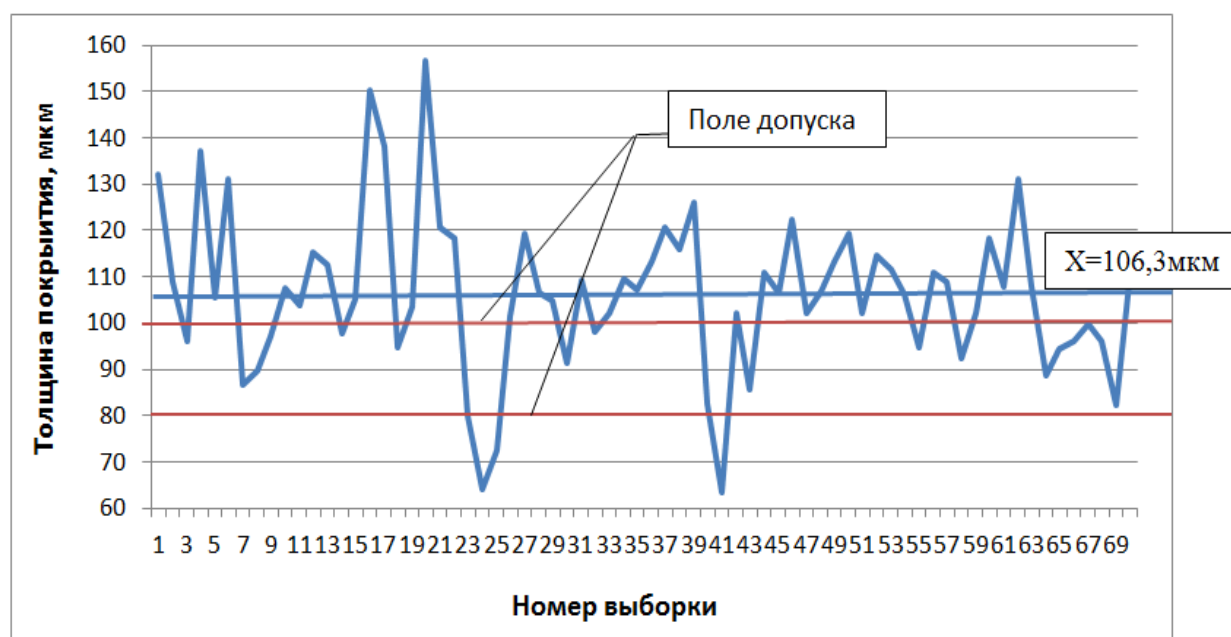
Рисунок 3 — Колебание толщины лакокрасочного покрытия левой части рамки
