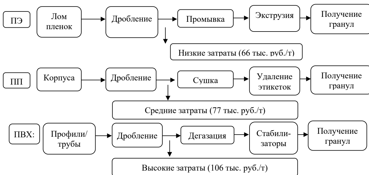
Рисунок 2 – Сравнительная схема технологических цепочек переработки отдельных видов полимеров [7]
